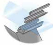
Los perfiles de fijación se utilizan para fijar y tensar la lona.
